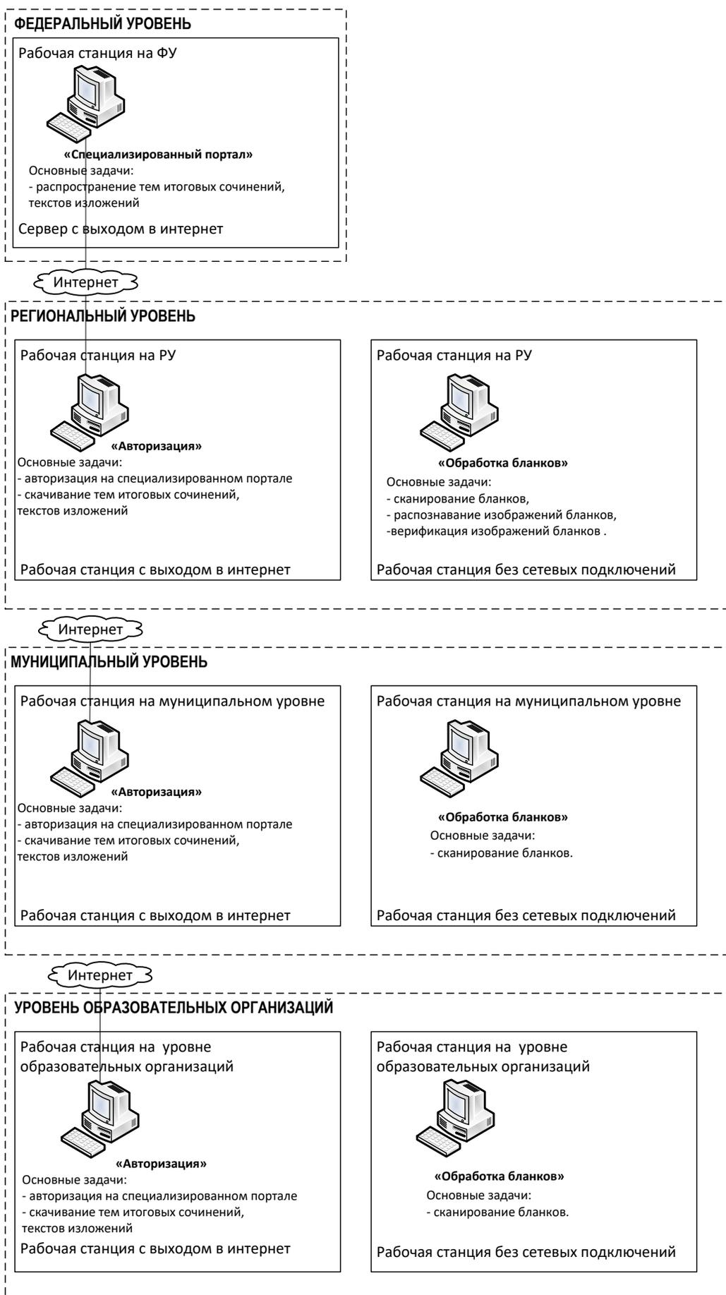
Рисунок 1. Архитектура и состав ПО
